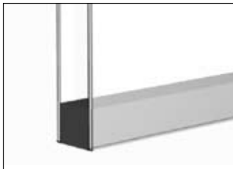
Zweischeiben-Isolierglas Wärmedurchgangskoeffizient U=2,7 \text{ W}/(\text{m}^2 \text{ K})
